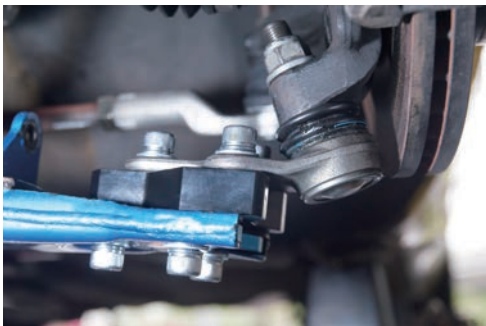
#7651 RC 墊片加高 20mm. Camber 調整
