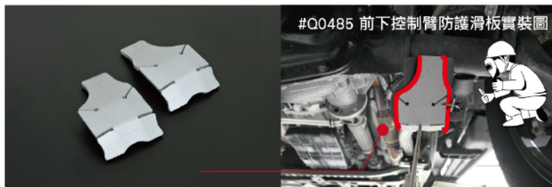
(此防護板需使用電焊方式將護蓋焊接至下控制臂鎖點)
