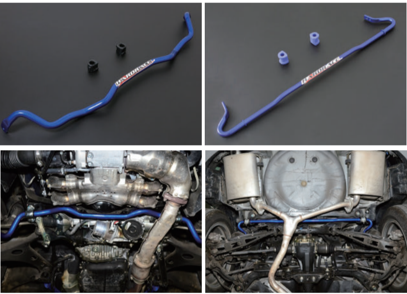
7688 前防傾桿 (28mm) 7669 後防傾桿 (22mm)
