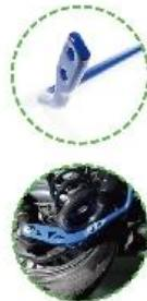
HARDRACE 研製前30mm、後加裝型19mm 防傾桿，以強化車輛的平衡穩定。#8795 為可調設計(雙孔)，可依車主需求調整軟硬的設定，以強化後側操控性。防傾桿桿身以 CR-MO 鉻鋁合金鋼材，具備高剛性及高彈性的優點，透過反作用力作動，有效抑制側傾，尤其在高速轉向時，更能明顯感受強化防傾桿穩持車輛的牽引力與抓地力，並優化懸掛系統效能。
