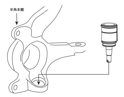
※ 使用液壓工具將和尚頭壓入羊角,安裝前 先將防塵套取下,避免防塵套夾傷及破損
