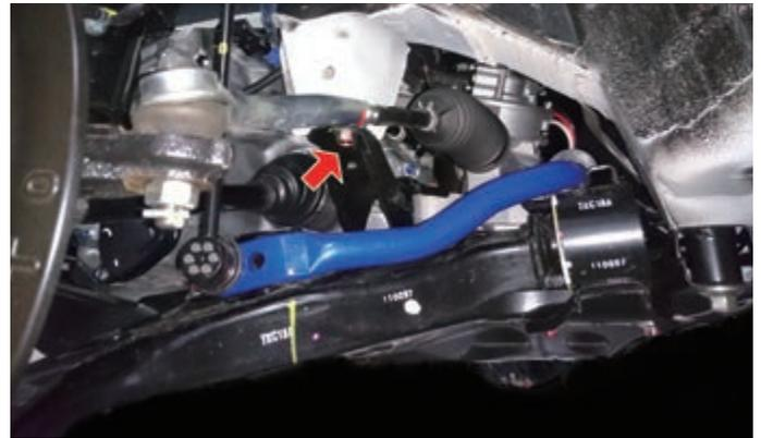
下護板部分拆除後，使用變速箱千斤頂工具，頂住大樑後端，將紅色箭頭處螺絲拆卸，將白色箭頭處螺絲放鬆4~5牙即可，將大樑斜後分離即可更換防傾桿
